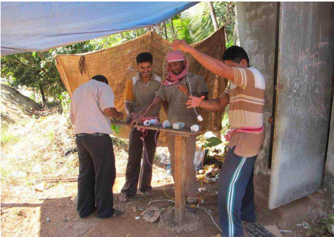
Auch die Elektriker konnten noch neue Schaltungsarten kennenlernen. Sie kannten bis jetzt nur eine Flurbeleuchtung mit 2 Lichtschaltern. Nach einer Stunde üben waren sie in der Lage, eine Flurbeleuchtung mit mehreren Schaltern zu montieren. (Ich hoffe, sie haben es wirklich verstanden.)
